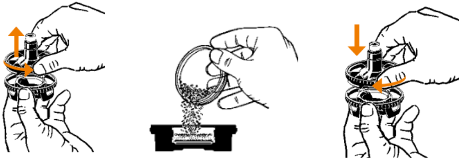
ΑΦΑΙΡΕΣΗ ΤΟΥ ΚΑΠΑΚΙΟΥ ΑΠΟ ΤΟΝ ΘΑΛΑΜΟ ΠΛΗΡΩΣΗΣ, ΠΛΗΡΩΣΗ ΤΟΥ ΘΑΛΑΜΟΥ ΠΛΗΡΩΣΗΣ ΜΕ ΤΗΝ ΑΠΑΙΤΟΥΜΕΝΗ ΔΟΣΗ ΚΑΙ ΕΠΑΝΑΝΑΤΟΠΟΘΕΤΗΣΗ ΤΟΥ ΚΑΠΑΚΙΟΥ
